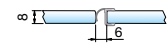
Art.-Nr. 8865KU0-8-2010 Art.-Nr. 8865KU0-8-2500 für 8 mm Glas für ein einseitig öffnendes Duschtürband
