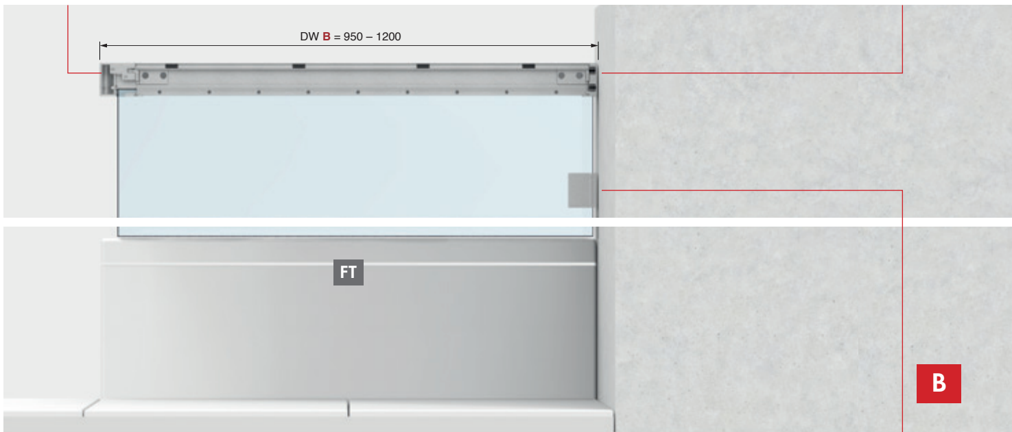
Wandhalter am Seitenteil wall bracket on the side panel Art.-Nr.: | art no.: 8822ZN_-EL/ER
