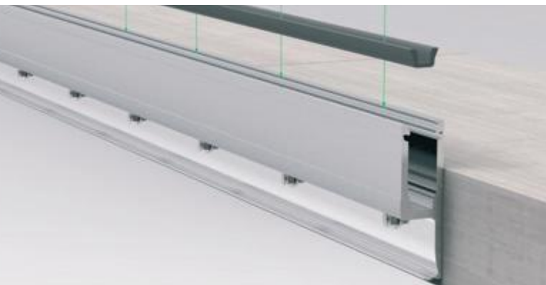
2. Unteres Verglasungsprofil einsetzen (im Außenbereich an den Entwässerungsbohrungen aussparen) Insert lower glazing profile (for outdoor usage, blank out at the drain holes)
