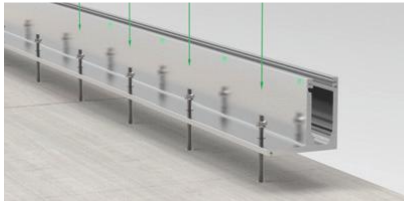
1. Anschrauben des Profils | Mount the profile
